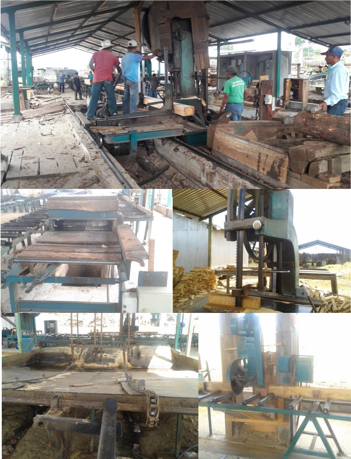
Imagen 9. Aserradero, Cuñero, Medidor, Desorillador, Hojeador, Péndulo, Trimer y tina de baño
