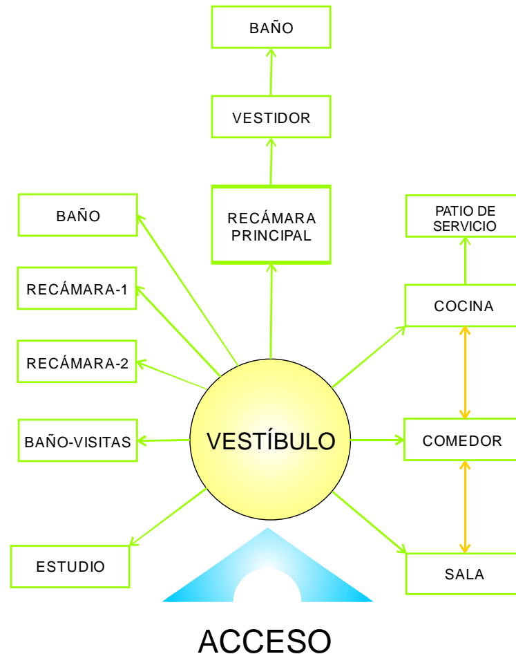
FIGURA 7: Diagrama de funcionamiento del prototipo de vivienda.
